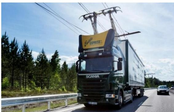
Este sistema, desarrollado por Siemens, en teoría se puede acoplar a cualquier camión híbrido o eléctrico.
